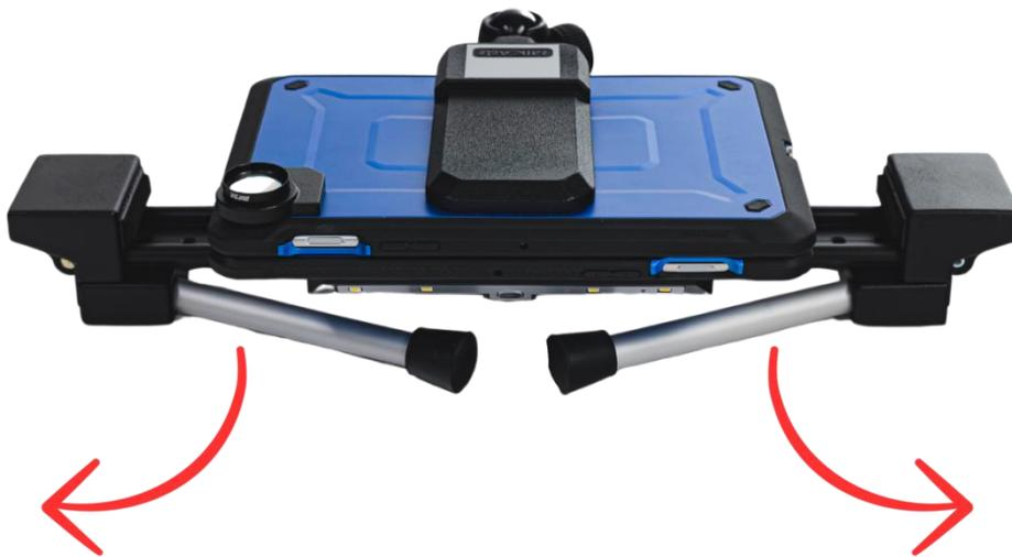
2. Den Deckel mit dem oberen Bildschirm anheben. Der Halterungsarm, auf dem der obere Bildschirm montiert ist, ist mit Drehknöpfen ausgestattet, die zur Einstellung der Position des Bildschirms und zur Regulierung des Widerstands dienen, mit dem die Halterung arbeitet. Dies ermöglicht eine präzise Einstellung der Bildschirmposition.
