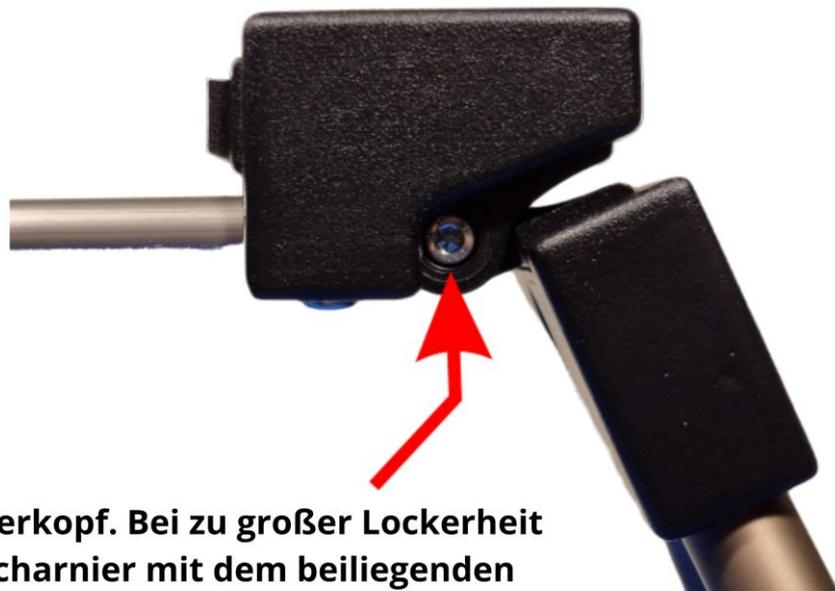
Schwenkreglerkopf. Bei zu großer Lockerheit muss das Scharnier mit dem beiliegenden Inbusschlüssel nachjustiert werden.
